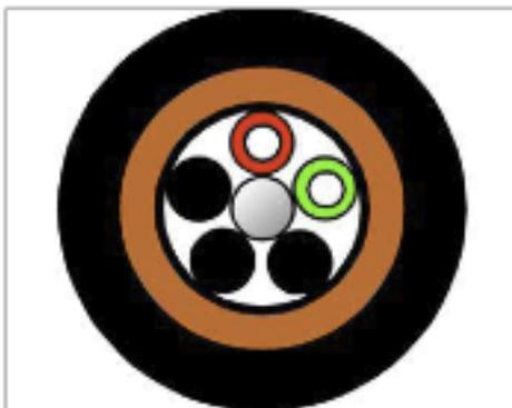
Eine 100-prozentige Nagetiersicherheit kann ausschließlich durch metallische Aufbauelemente erreicht werden. Üblich sind dabei entweder Stahlwellmäntel bzw. Stahldrahtgeflechte oder aber eine Verlegung herkömmlich geschützter Kabel in metallene Schutzrohre.
