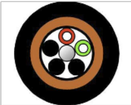
Eine 100-prozentige Nagetiersicherheit kann ausschließlich durch metallische Aufbauelemente erreicht werden. Üblich sind dabei entweder Stahlwellmäntel bzw. Stahldrahtgeflechte oder aber eine Verlegung herkömmlich geschützter Kabel in metallene Schutzrohre.
