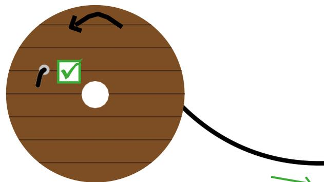
Loses Kabelende - Überlänge des Kabels wird nach außen gedrückt
